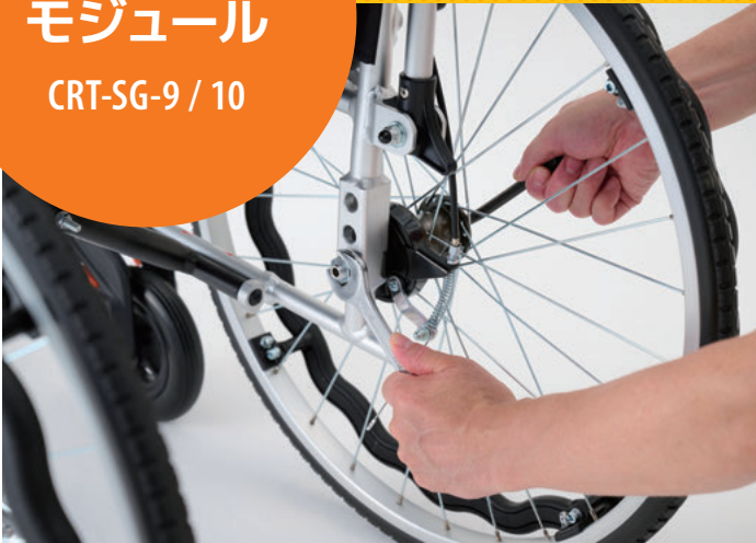
座面高モジュール：穴の位置を変えるだけ。
