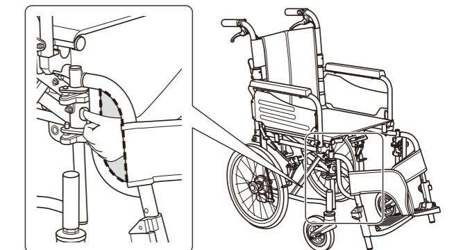
使用する前に駆動輪(主輪)・キャスター・駐車用ブレーキ、各調節部等のネジを点検し、緩んでいるときは増し締めをしてください。
