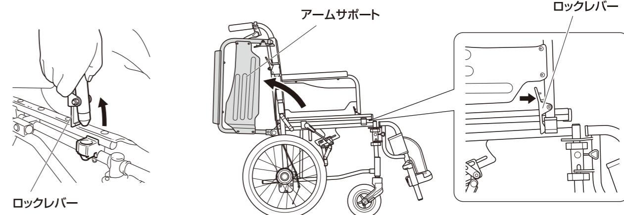
\*アームサポートを上げた状態で、アームサポートに力を加えないでください。フレームが変形し故障の原因となります。
