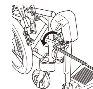
2 フット・レッグサポートの角度を調節し、希望の角度の穴にボルトを取り付けます。
