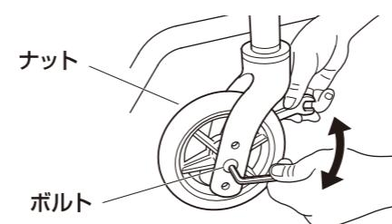
3 前ページ「駆動輪（主輪）とキャスターの調節範囲」に従って、駆動輪と同じ高さ設定になる取付け穴にボルトを進行方向に対し右側から差し込み、しっかりとナットを締め込みます。
