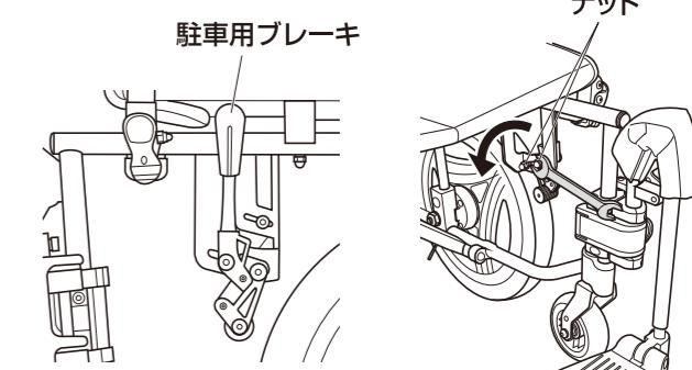
2 駐車用ブレーキをかけたときに、タイヤに駐車用ブレーキのタイヤ押えが当たり、駆動輪がしっかり止まる位置に調節します。
