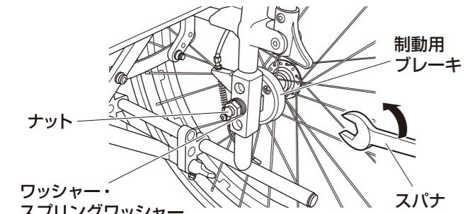
3 駆動輪（主輪）を取り付ける穴を決め、駆動輪（主輪）の車軸を制動用ブレーキ等に通し、本体フレームに差し込みます。
