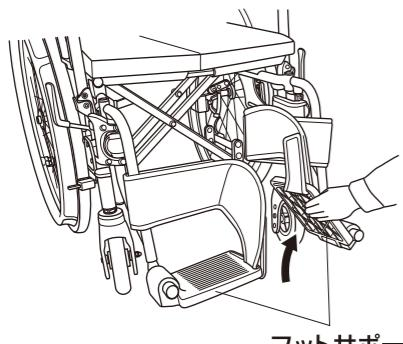
3 必要に応じて、フット・レッグサポートの開閉・取り外し」(P.12 参照)や、「アームサポートフレームの跳ね上げ」(P.11 参照)を行います。
