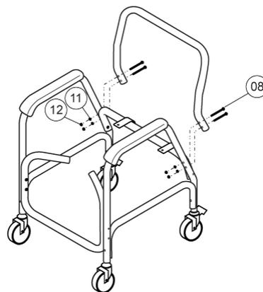
3. サイドフレーム に背シート部パイプ を取り付けます。ねじ(大) ,波ワッシャー ,ナット で固定してください。
