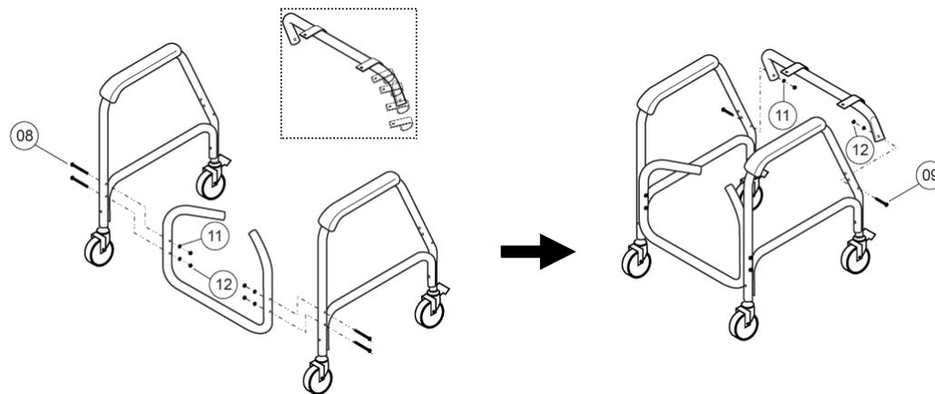
1. サイドフレーム に前部パイプ を取り付けます。ねじ(大) ,波ワッシャー ,ナット にて固定してください。
