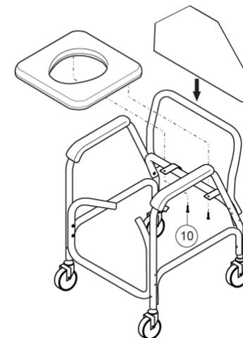
4. 座面板 をねじ(小) にて座面固定金具 に取り付けます。白布 を背シート部パイプ にかぶせると完成です。
