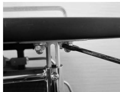
1. テーブル本体表の皿キャップボルトを六角レンチで固定しながら、ステー取付部の袋ナットをスパナで4箇所すべて緩めてください。また、取り付いていた締結部品は、再度使用しますので無くさないよう注意してください。
