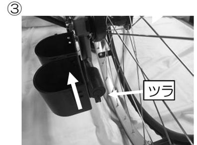
③ クランプを取付けたものをテッピングバーに差込みます。テッピングバーの先端とクランプがツラになるように位置を合わせます。
