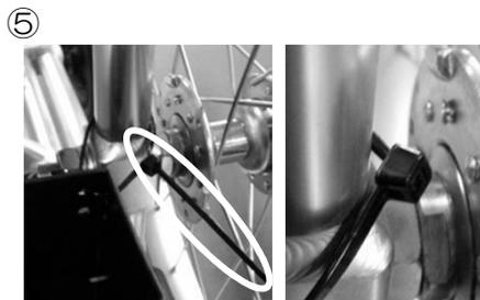
⑤ タイラップで杖入れを固定します。タイラップは締めていくと余分な箇所(写真、まる)ができますので、その余分な箇所をニッパーでカットします。
