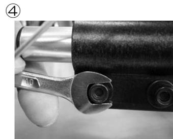
④ 本体カップが垂直になるよう調節し、10mmスパナで2箇所を締め、クランプを固定します。目安は自重で倒れない程度です。
