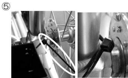
タイラップで杖入れを固定します。タイラップは締めていくと余分な箇所(写真、まる)ができますので、その余分な箇所をニッパーでカットします。
