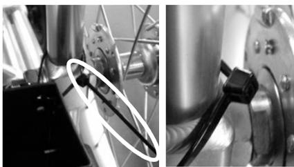
タイラップで杖入れを固定します。タイラップは締めていくと余分な箇所(写真、まる)ができますので、その余分な箇所をニッパーでカットします。
