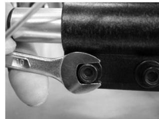
本体カップが垂直になるよう調節し、10mmスパナで2箇所をボルトを締め、クランプを固定します。
