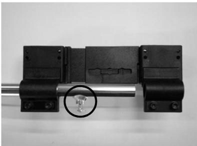
固定用ボルト(写真、まる)側からパイプをクランプから抜き取ります。
