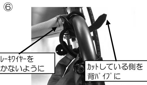
押手パイプを巻きつけるように、背シート上に固定用バンドを取り付けます。※オス側が露出しないように
