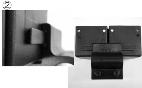
② ①で組み付けたものにクランプが中央にくるように取り付けます。
