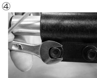
本体カップが垂直になるよう調節し、10mmスパナで2箇所を締め、クランプを固定します。目安は自重で倒れない程度です。
