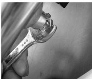
延長テッピングバーの付いている固定用ボルト(M6×20)を下に向け10mmスパナで締めつけ、延長テッピングバーが動かないよう固定します。
