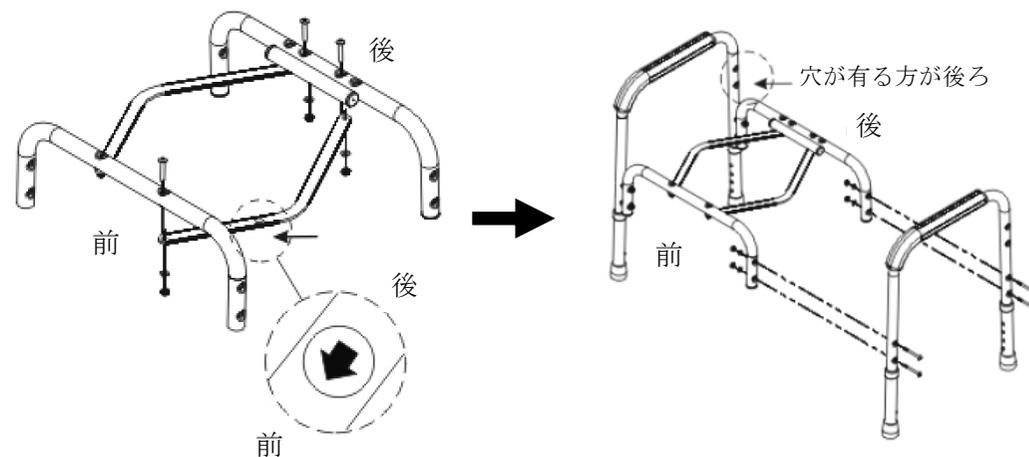
1. 前部フレーム③、後部フレーム④にバケツ受け金具⑤を取り付けます。ねじ(小)⑨、平ワッシャー⑬、ナイロンナット⑫で固定してください。バケツ受け金具の矢印の向きに注意してください。
