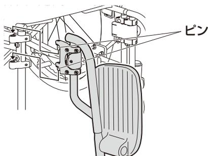
2 フット・レッグサポートを内側に回転させて閉じます。閉じた後、フット・レッグサポートが完全にロックされたことを確認します。
