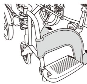
レッグサポートの幅狭側の端をフットサポート先端の前後どちらかの穴に差し込みます。
