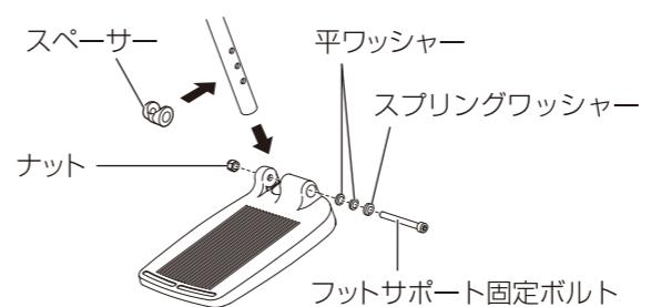
3 脚の長さに合わせてフットサポートの高さを調節します。
