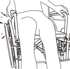
!**段差乗り越え時等でキャスターを上げる際は必ず押手ハンドルを手前に引くと同時に足元のティッピングレバーを押し出して下さい。**
