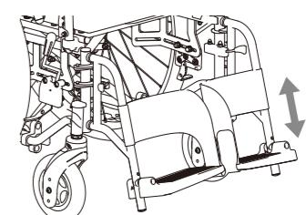
4 希望の高さの穴を決めたら、固定ボルトを差し込み、
