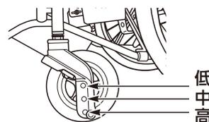
**1** キャスタフォークの溝に、車輪を挿入します。
