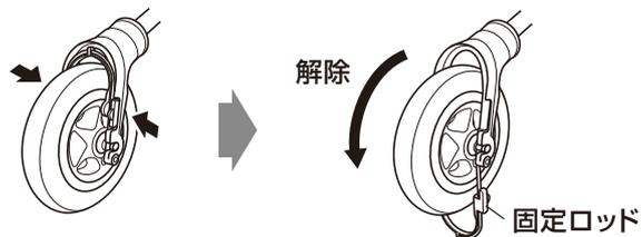
**4** 車輪を上引っ張って、車輪を外します。
