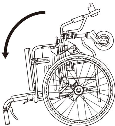
3 キャスタフォークの固定ロッドを両側から指ではさみ、矢印の方向に動かしてロックを解除します。
