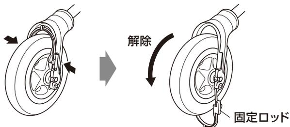
4 車輪を上引っ張って、車輪を外します。
