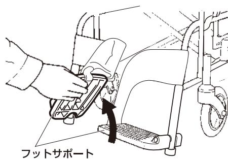
**8** 座アウターシートの前後を持ち上げ、シートパイプを引き寄せます。
