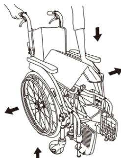
片側の駆動輪(主輪)を浮かせる
