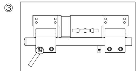
③ 本体カップが垂直になるよう調節し、10mmスパナで2箇所ボルトを締め、クランプを固定します。締付トルクは2.0N・mです。目安としては、自重で倒れない程度です。
