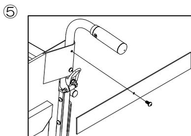
⑤ 背シート最上部のビスをドライバーで一旦はずします。ビスを固定バンドの穴に通し、固定バンドを挟む様に再度取り付け、固定バンドを固定します。
