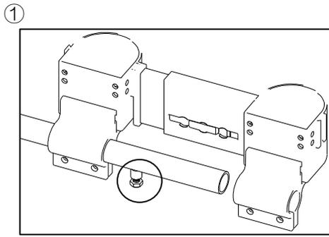
① 固定用ボルト(図、まる)側からパイプをクランプから抜き取ります。
