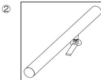
② 延長テッピングバーの付いている固定用ボルト(六角M6×20)を下に向け10mmスパナで締めて延長テッピングバーが動かないよう固定します。
