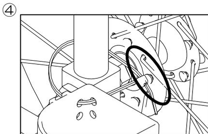
④ タイラップで杖入れを固定します。タイラップは締めていくと余分な箇所(図、まる)ができますので、その余分な箇所をカットします。
