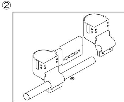
② パイプを抜いたクランプを調節ステーから外します。
