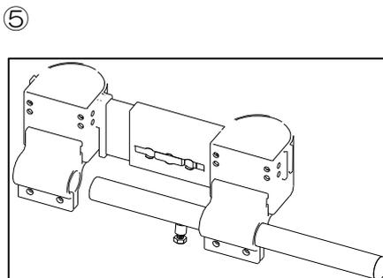
⑤ ④でパイプを差し込んだクランプを調節ステーに取り付けます。
