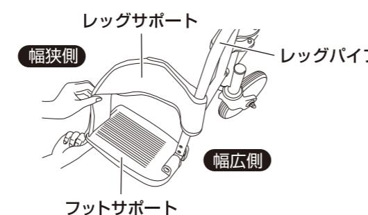
5 レッグサポートの幅狭側の端をフットサポート先端の前後どちらかの穴に差し込みます。
