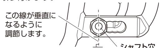
4 駆動輪を車軸受けに差し込みます。
