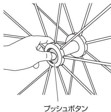
2 車軸中心のプッシュボタンを押しながら、車軸ごと駆動輪をまっすぐに引き抜きます。
