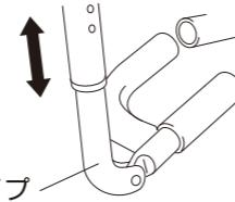
**4** 高さを決めたら、キャップボルトを差し込み、反対側にナットを締め付けて固定します。
