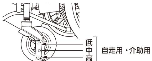
1 キャスターフォークの溝に、車輪を挿入します。
